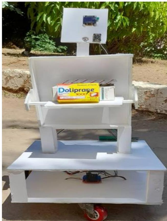
Figure III.7 : Robot aide-soignant réalisé -résultat final-.
