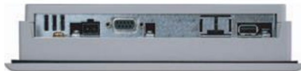
Figure 2.19 : Vue de dessous d'un TP 177B 6" DP [40]
