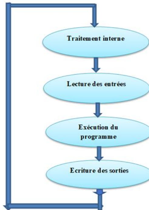
Figure 3.4 : Traitement du programme automate
