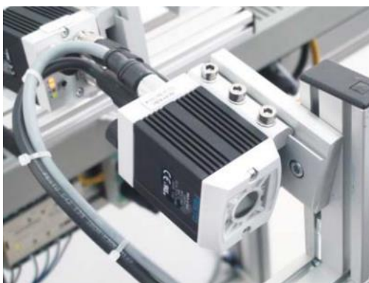
Figure 2.24 : Caméra FESTO SBSI [41]
