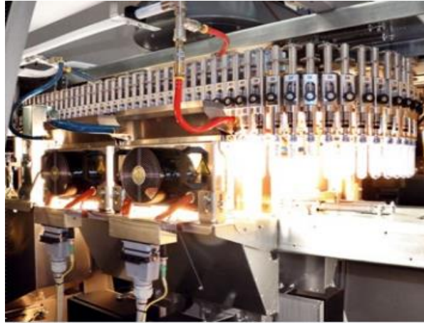
Figure 1.20 : Module de chauffage [12]
