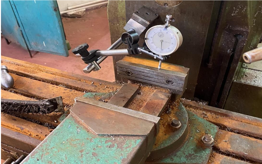
Figure 5. 4 Réglage d'un étau de fraiseuse par le comparateur
