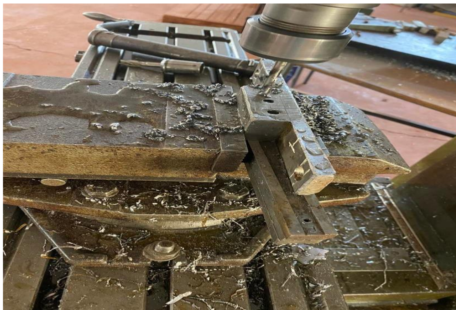
Figure 1. 3 Opération de perçage
