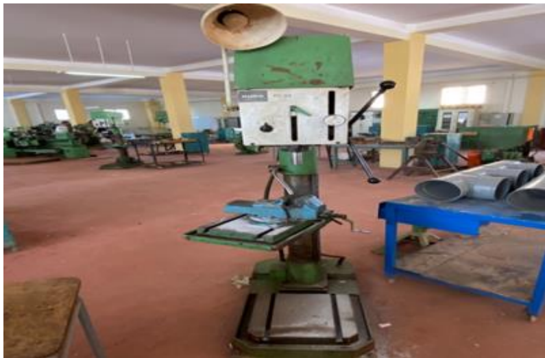
Figure 1. 8 Perceuse à colonne ALMO
