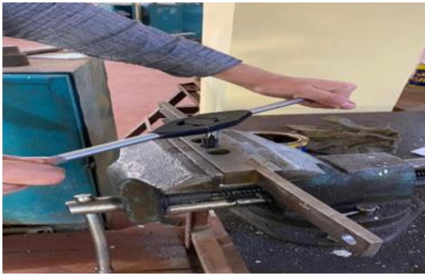
Figure 5. 11 Opération de taraudage
