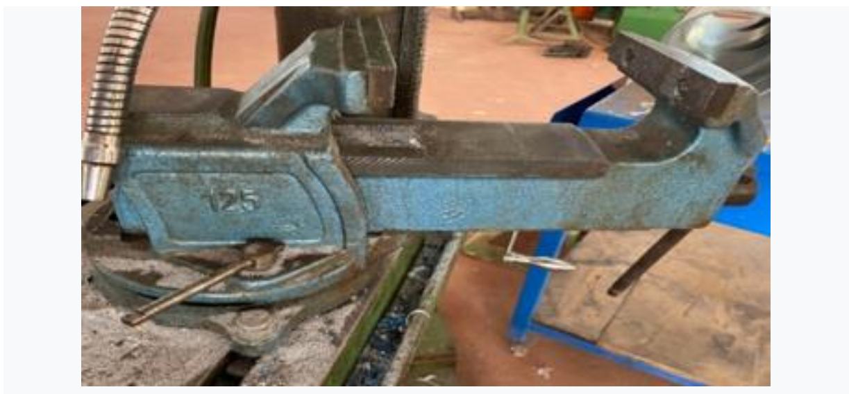
Figure 1. 15 Etou de perceuse
