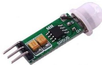
**Figure II. 13:** capteur de mouvement « PIR »
