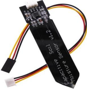
**Figure II. 10:** capteur d'humidité de sol capacitif
