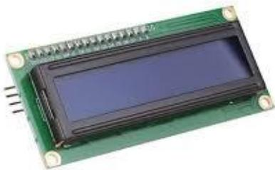
**Figure II. 19:**Afficheur LCD
