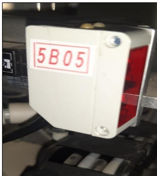
Figure II-32: Capteur réflecteur
