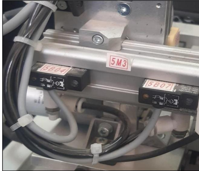
Figure II-33: Capteurs magnétiques
