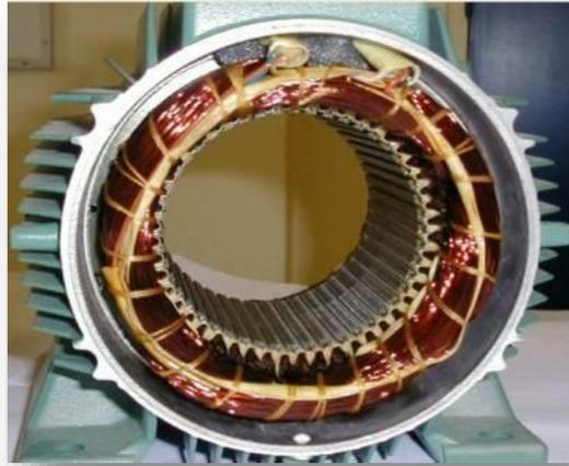
**Figure I.1:** L'enroulement triphasé du stator [4]
