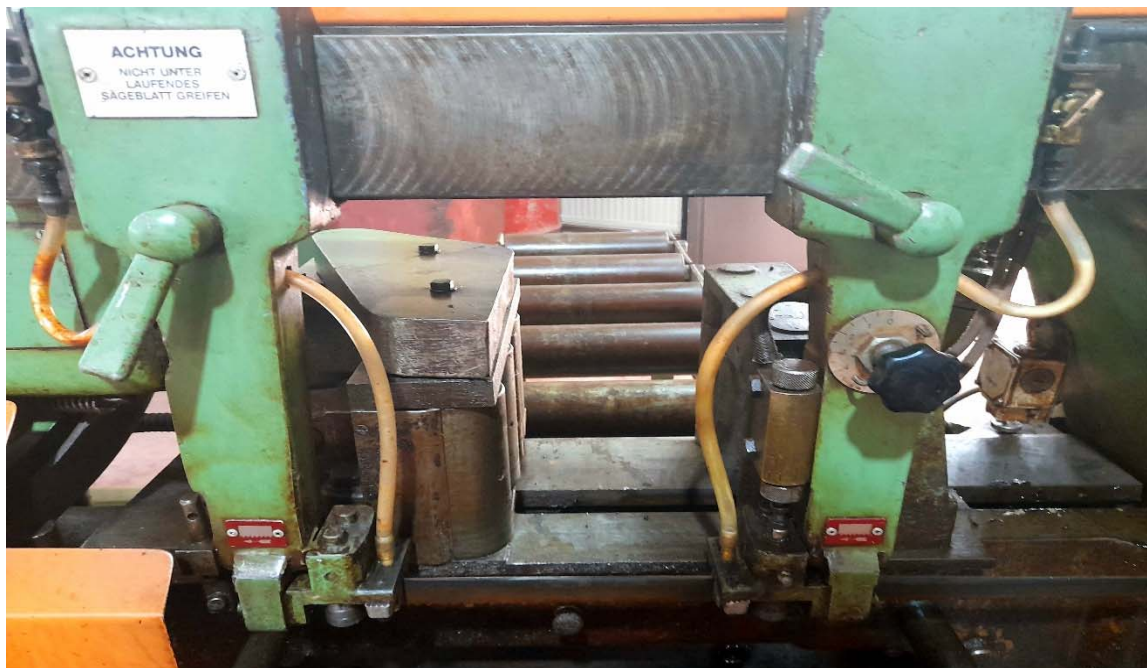
Figure V.10 Changement des tuyaux colmatés
