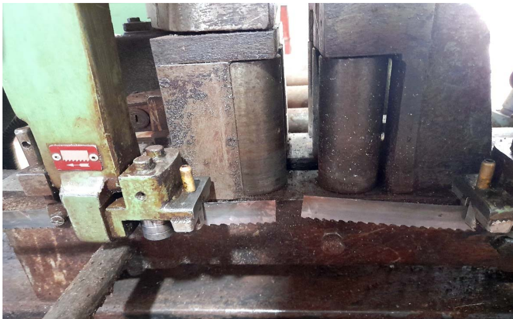
Figure V.2 Cassure de la lame
