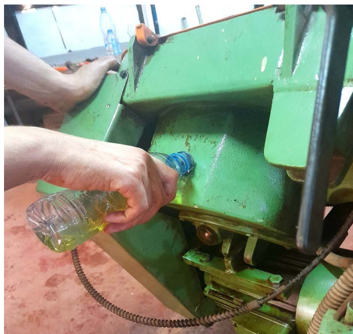
Figure V.14 Remplissage d'huile pour le moteur
