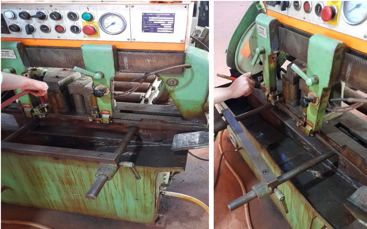
Figure V.9 Nettoyage de la machine
