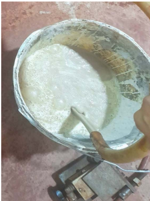
Figure V.12 nouveau lubrifiant dans le réservoir
