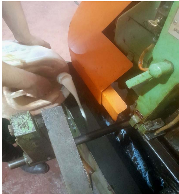
Figure V.12 nouveau lubrifiant dans le réservoir
