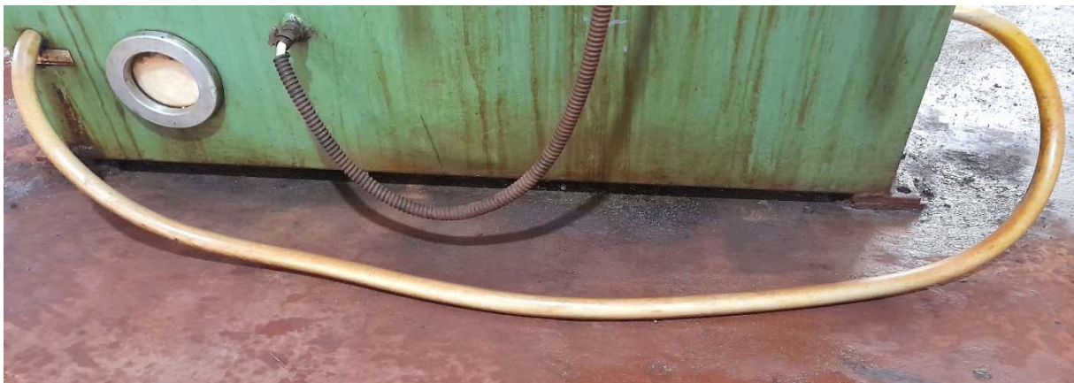
Figure V.16 Changement de tuyaux de retour du lubrifiant
