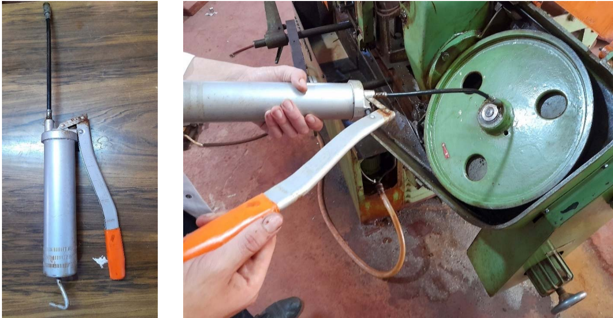
Figure V.15 Opération de graissage
