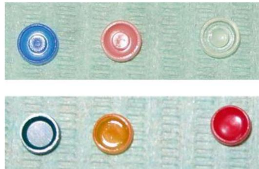
**Figure 6 : Les inserts de rétention en Nylon avec différentes forces de rétention matérialisées par des couleurs différentes**
