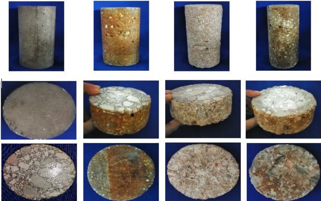
Figure III.4 a. Etat des bétons sains et dégradés
