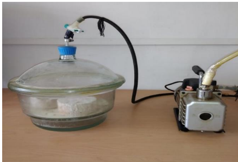
Figure II.16. Dispositif pour la mesure de la porosité accessible à l'eau
