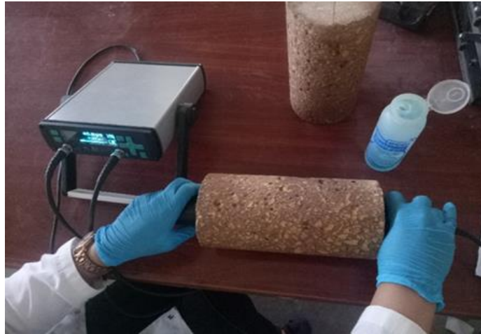
Figure II.15. Test de la vitesse d'impulsion ultrasonique des échantillons
