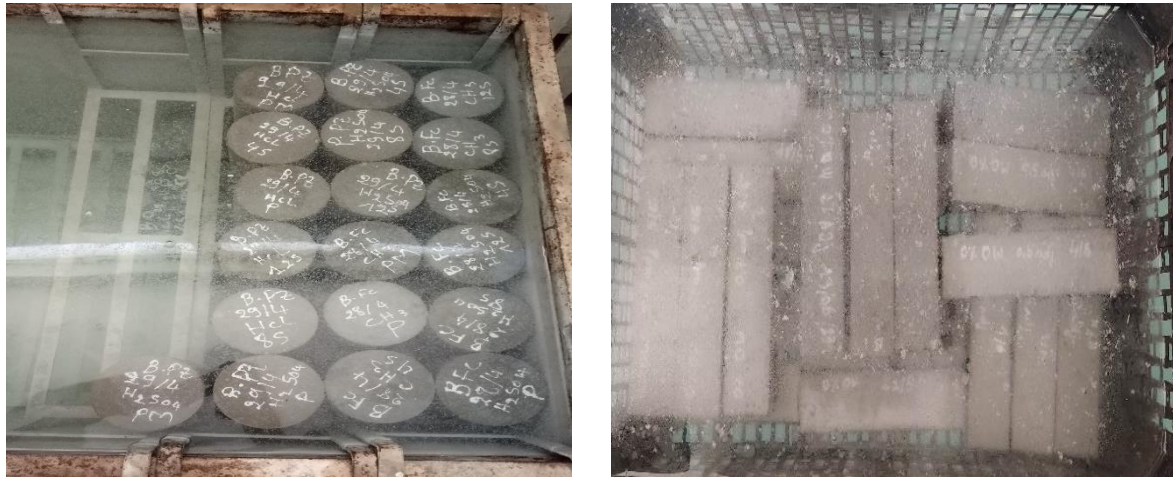
Figure II.7. Conservation des éprouvettes dans l'eau saturée par la chaux
