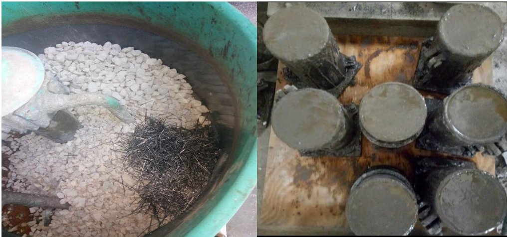
Figure II.4. Malaxage et Coulage des éprouvettes en béton
