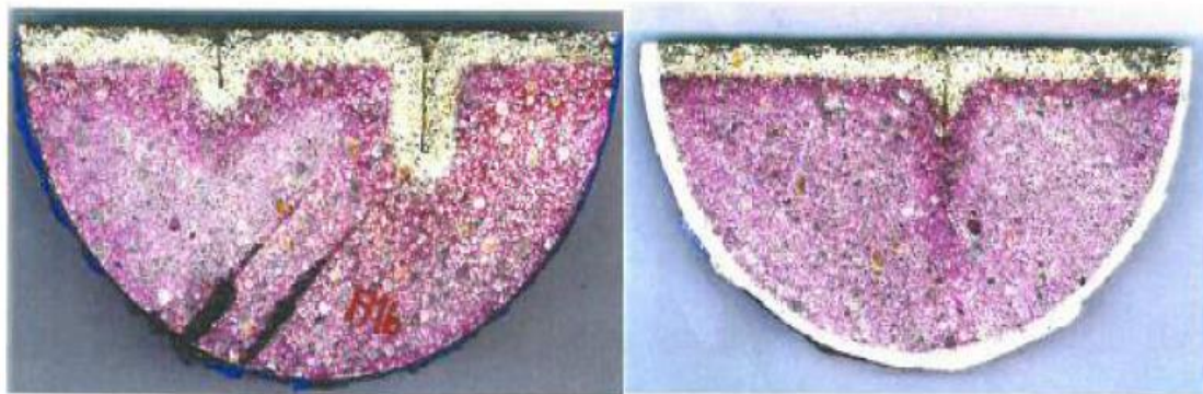
Figure I.25. Profil de dégradation dans la section droite d'une éprouvette fissurée
