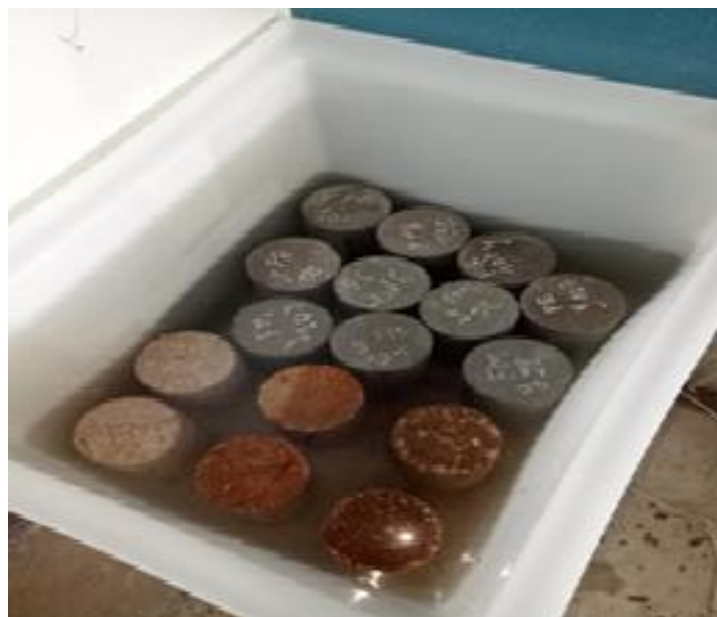
Figure II.10 Essai de dégradation accélérée au nitrate d'ammonium
