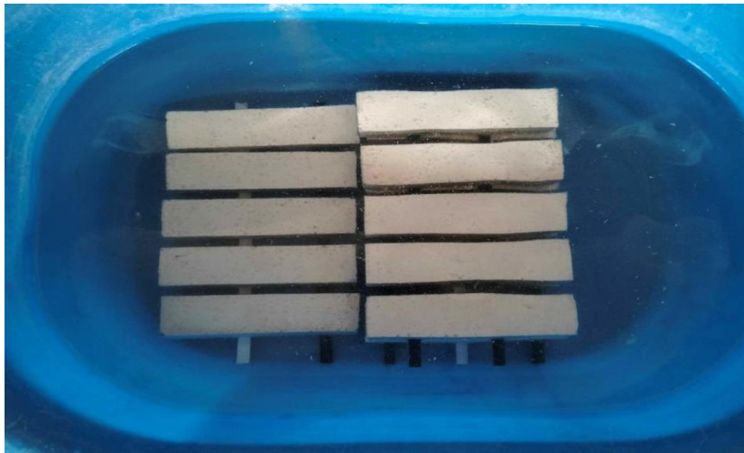
Figure 43: Les échantillons dans l'eau (Cycle Etuve-Immersion)
