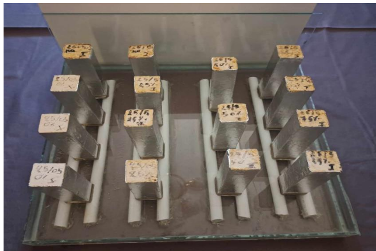
Figure 42: Essai d'absorption capillaire
