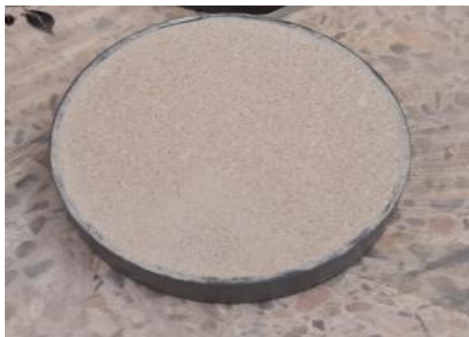
Figure 36: Eprouvettes réalisées Ø (80mm) épaisseur de 1cm
