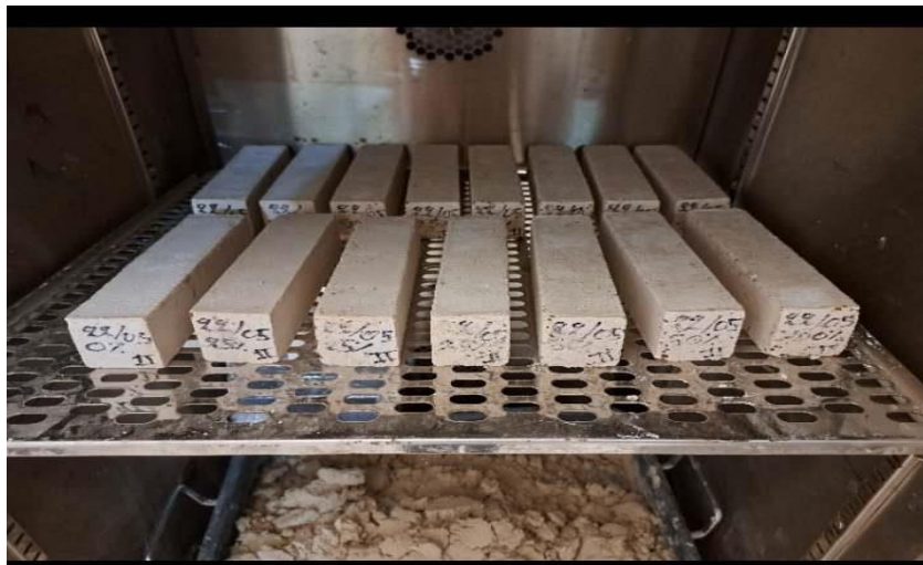
Figure 44: Les échantillons dans l'étuve (Cycle Etuve-Immersion)
