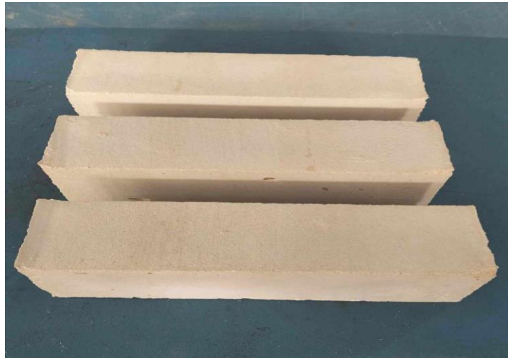
Figure 38: Epreuves réalisées (4×4×16 cm 3 )
