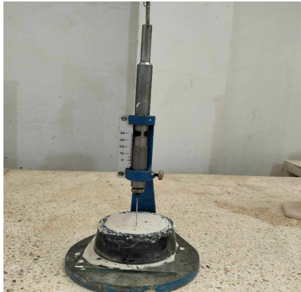
Figure 28: Essai de prise avec l'appareil Vicat
