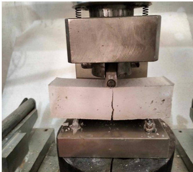
Figure 40: Dispositif pour l'essai de résistance à la traction
