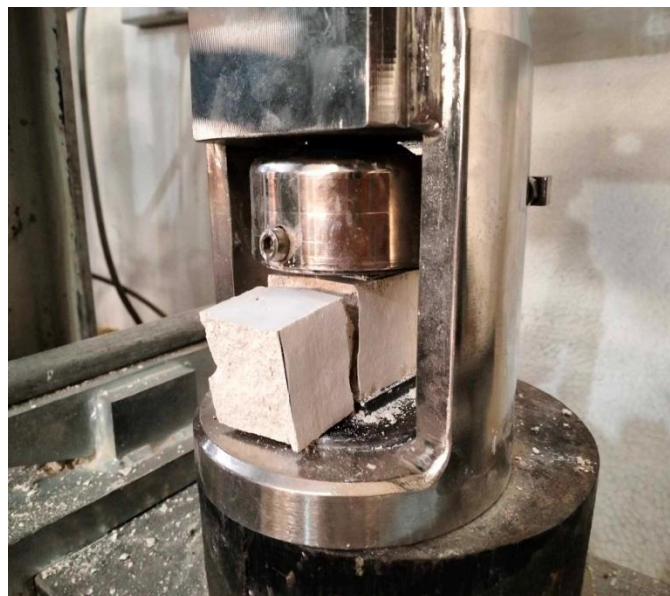
Figure 41: Dispositif pour l'essai de résistance à la compression
