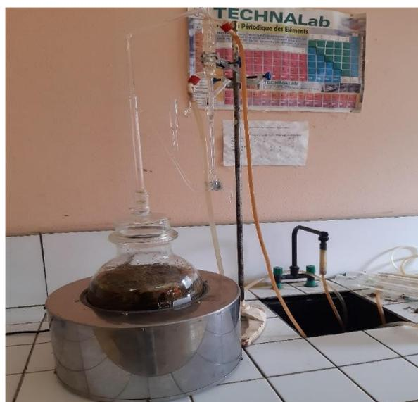
**Figure 44:** Montage d'hydrodistillation au laboratoire des substances naturelles et bioactives (LASNABIO).
