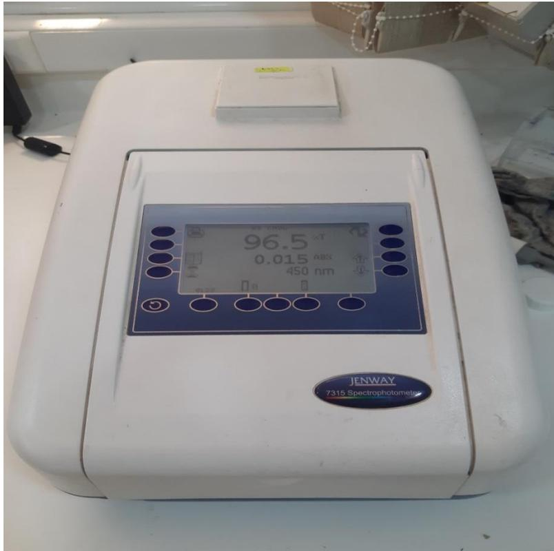
**Figure 39:** Spectrophotomètre type JENWAY 7315 au laboratoire du service de biochimie.
