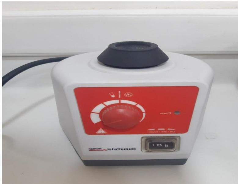
**Figure 43:** Vortex HumaTwist (Human) au laboratoire du service de biochimie.
