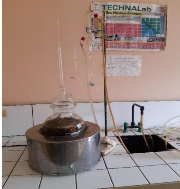
**Figure 37:** Hydrodistillateur type Clevenger au laboratoire des substances naturelles et bioactives (LASNABIO).
