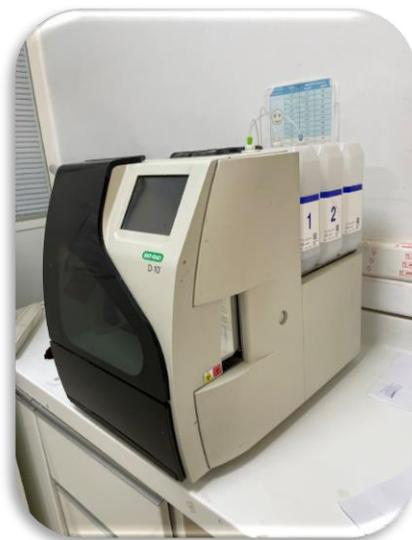
**Figure 10:** Bio-Rad D10 (mesure du HbA1c).
