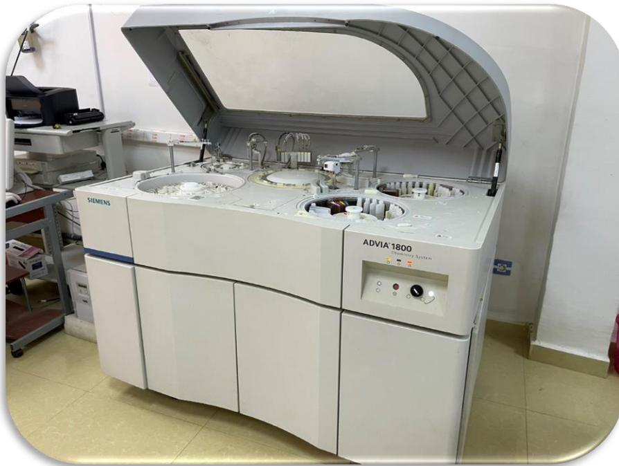
**Figure 11:** Automate SIEMENS ADVIA 1800, pour la mesure des paramètres biochimiques et l'ionogramme sanguin.
