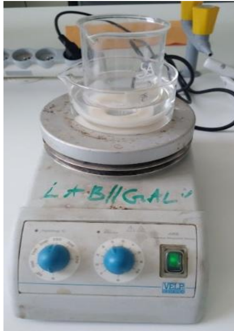
Figure 10 : chauffage d'une des deux phases sous agitation.
