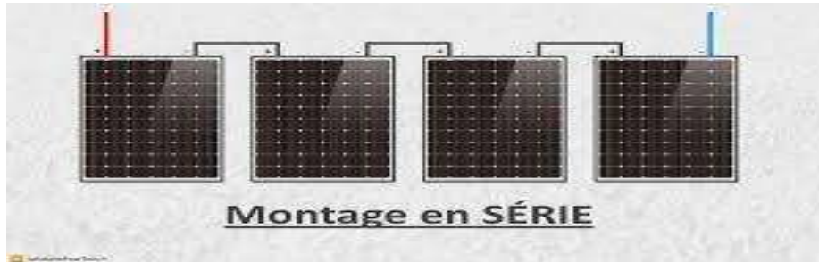
Figure III.9 : Schéma d'un montage en série des panneaux solaires (Lesolaire, 2023).
