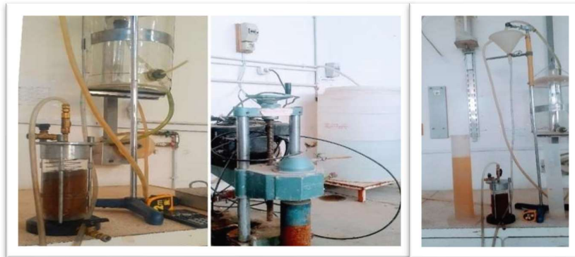
Figure IV.22: Essai de perméabilité à charge constante puis a charge variable
