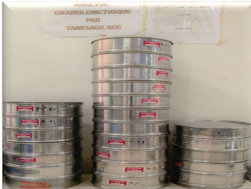
Figure IV.19: Une batterie de 18 tamis.
