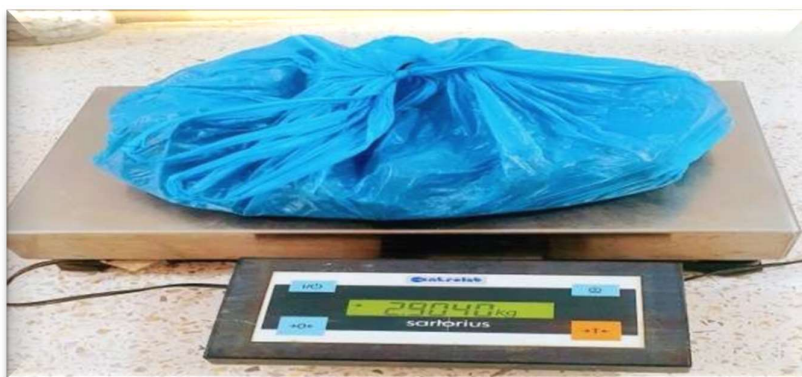
Figure IV. 18 : Mesure de la masse totale de l'échantillon de sol.
