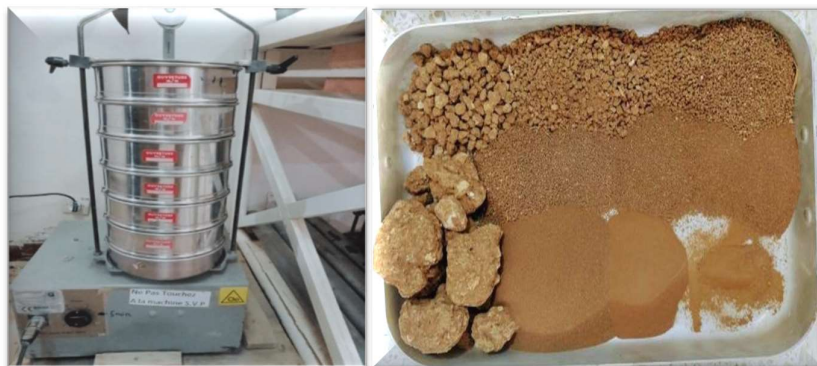
Figure IV.20 : Le vibrotamis électrique et les refus obtenus des tamis utilisés.
