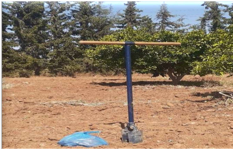
Figure IV.17 : La tarière ayant servi pour le prélèvement de l'échantillon du sol
