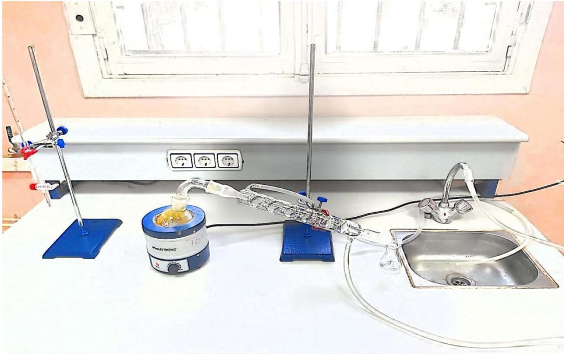
*Figure 17: montage de distillation*
