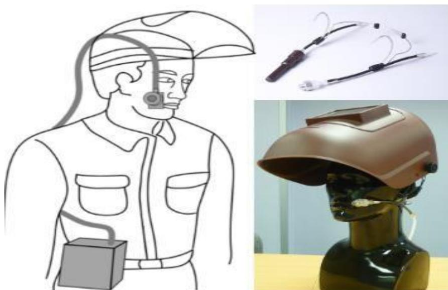
**Figure 11** : Position idéale de l'appareil de prélèvement d'air à l'intérieur de la visière du soudeur (152).
