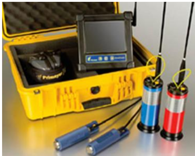
Figure I.12 Corrélateur pour la détection de fuites Eureka3
