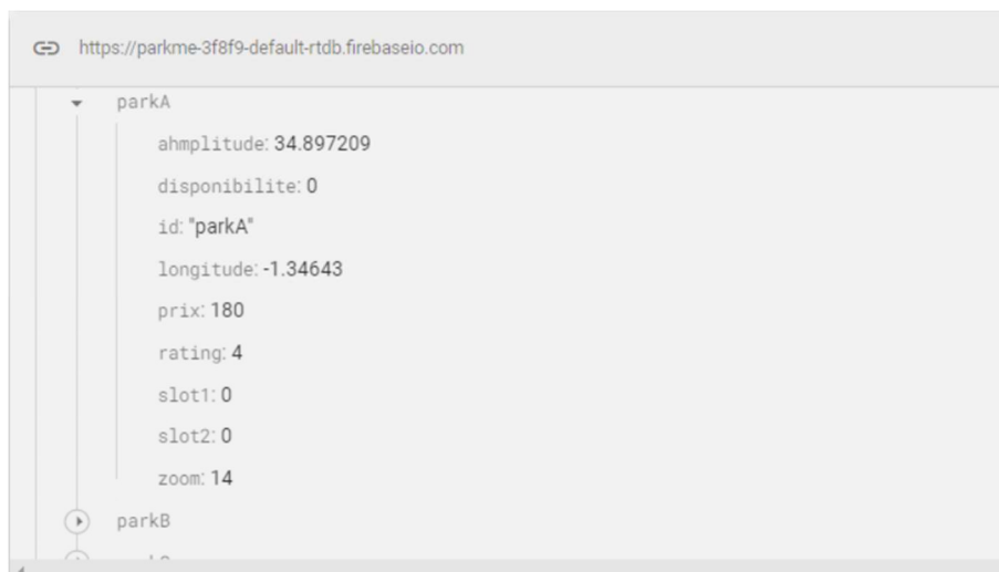
Figure 22: Création des capteurs IR sur Firebase.
