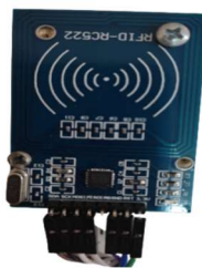
Figure 15: Capteur d'identification par radiofréquence (RFID).
