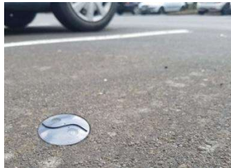
Figure 16 : Capteur sous-sol (Magnétomètre).
