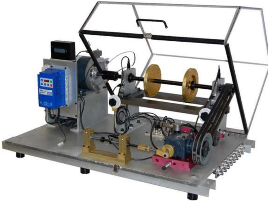
Figure 1.4. Simulateur de balourd et de courroie [13]
