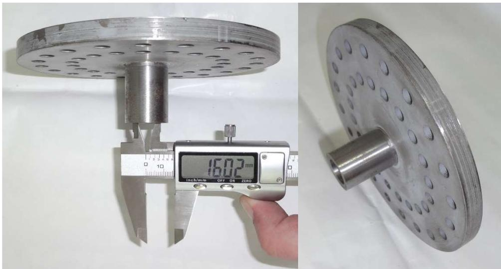
Figure 4.13. Réglage diamètre intérieur du disque
