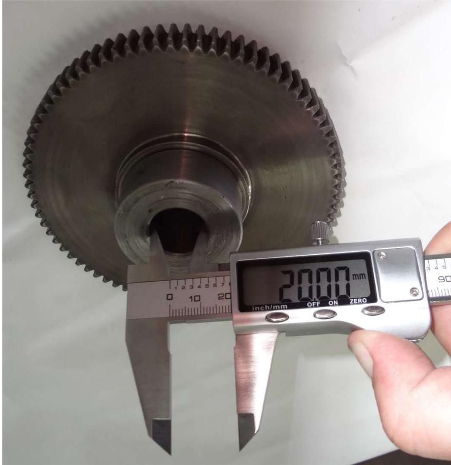
Figure 4.7. Mesure du pignon après usinage
