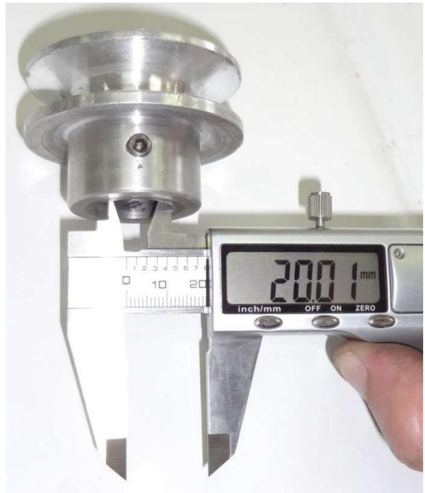
Figure 4.6. Pignons et Poulies après usinage
