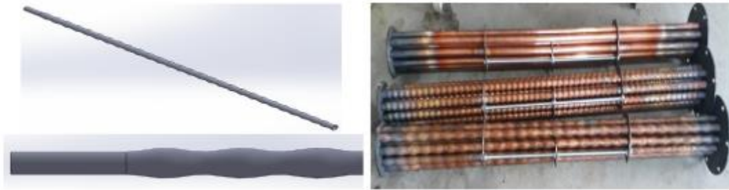
Figure I.29 : échangeur de chaleur à faisceaux et calandre.
