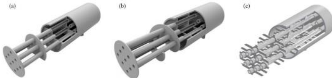
Figure I.22 : Trois types de chicanes utilisées (a)chicanes segmentaires (b)chicanes hélicoïdales (c) chicanes antivibratoires.
