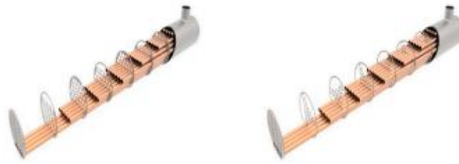
Figure I.32 : Différentes formes de chicanes.
