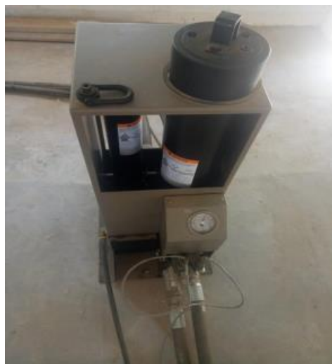
Figure 1.14: Le service hydraulique collecteur (HSM) de la table vibrante de RISAM [10].
