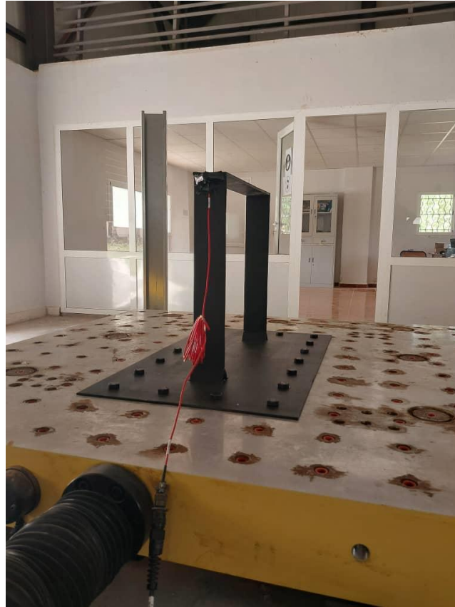
Figure 3.10: Accéléromètre fixé au portique.
