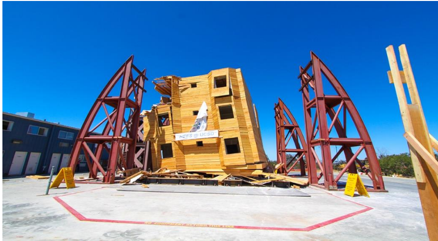
Figure 1.21: Test d'un bâtiment à ossature de bois de quatre étages sur la grande table vibrante extérieure de l'Université de Californie, San Diego [13].
