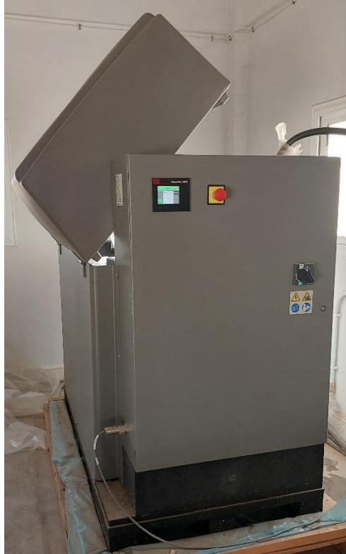
Figure 1.13: Le groupe hydraulique HPU (Hydraulic Power Unit) de la table vibrante de RISAM.
