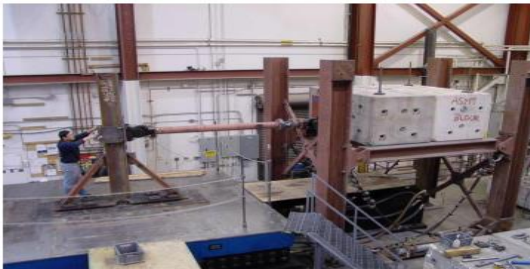
Figure 1.18: Spécimen résonant et système inertiel [12].
