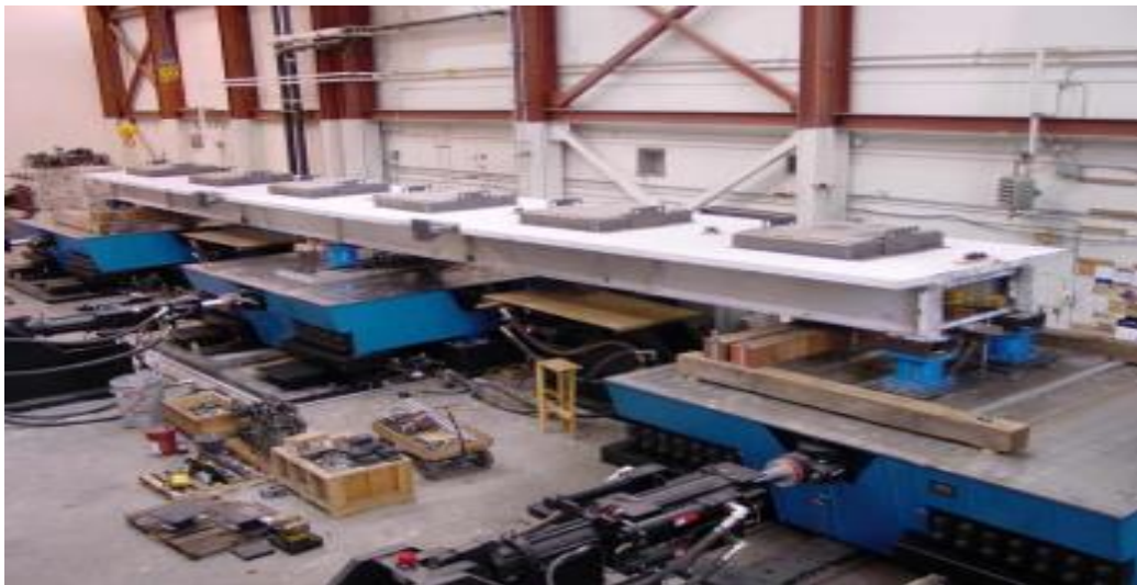
Figure 1.17: Système de table vibrante de l'université du Nevada, Reno [9].
