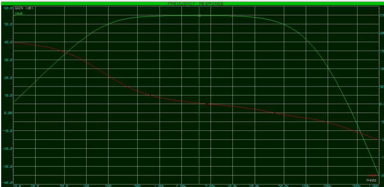
Figure 50 : Réponse en fréquence du filtre passe bande
