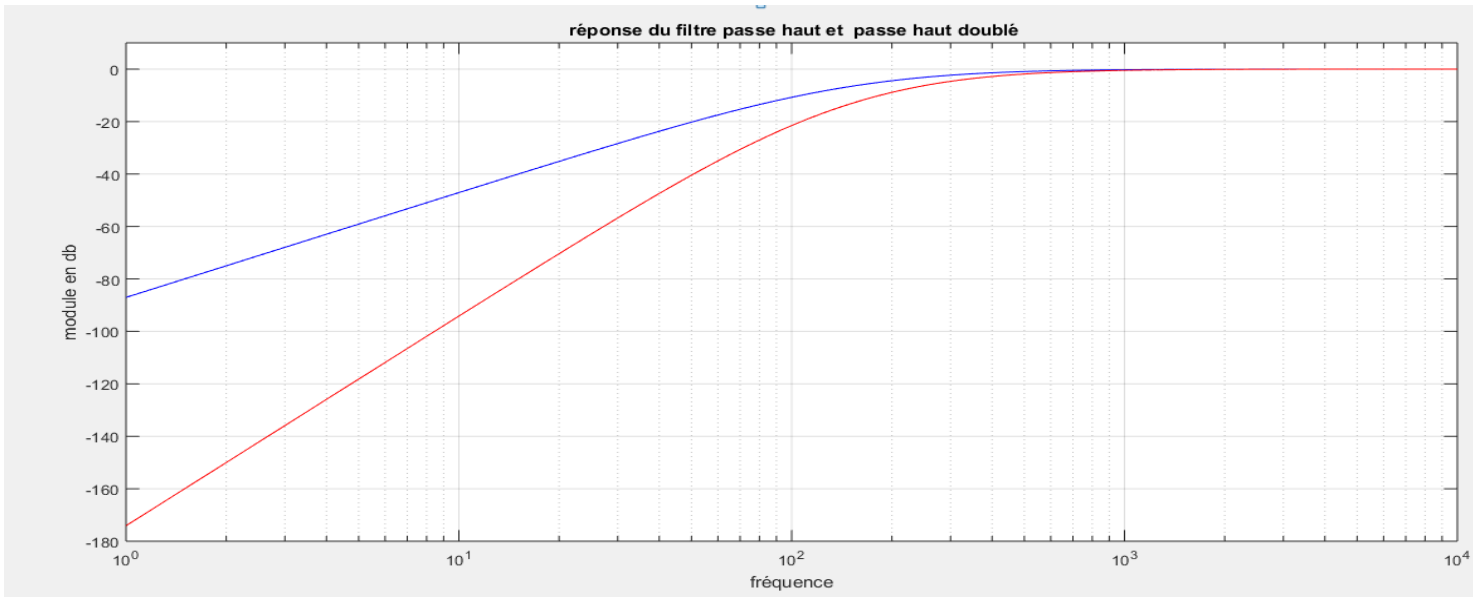
Figure 31 : La différence entre le filtre passe –haut et passe haut doublé.
