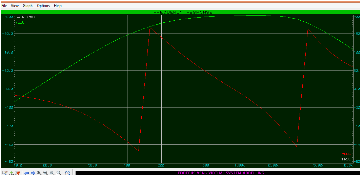
Figure48: La réponse en fréquence de filtre passe bande 1 simulé par ISIS.
