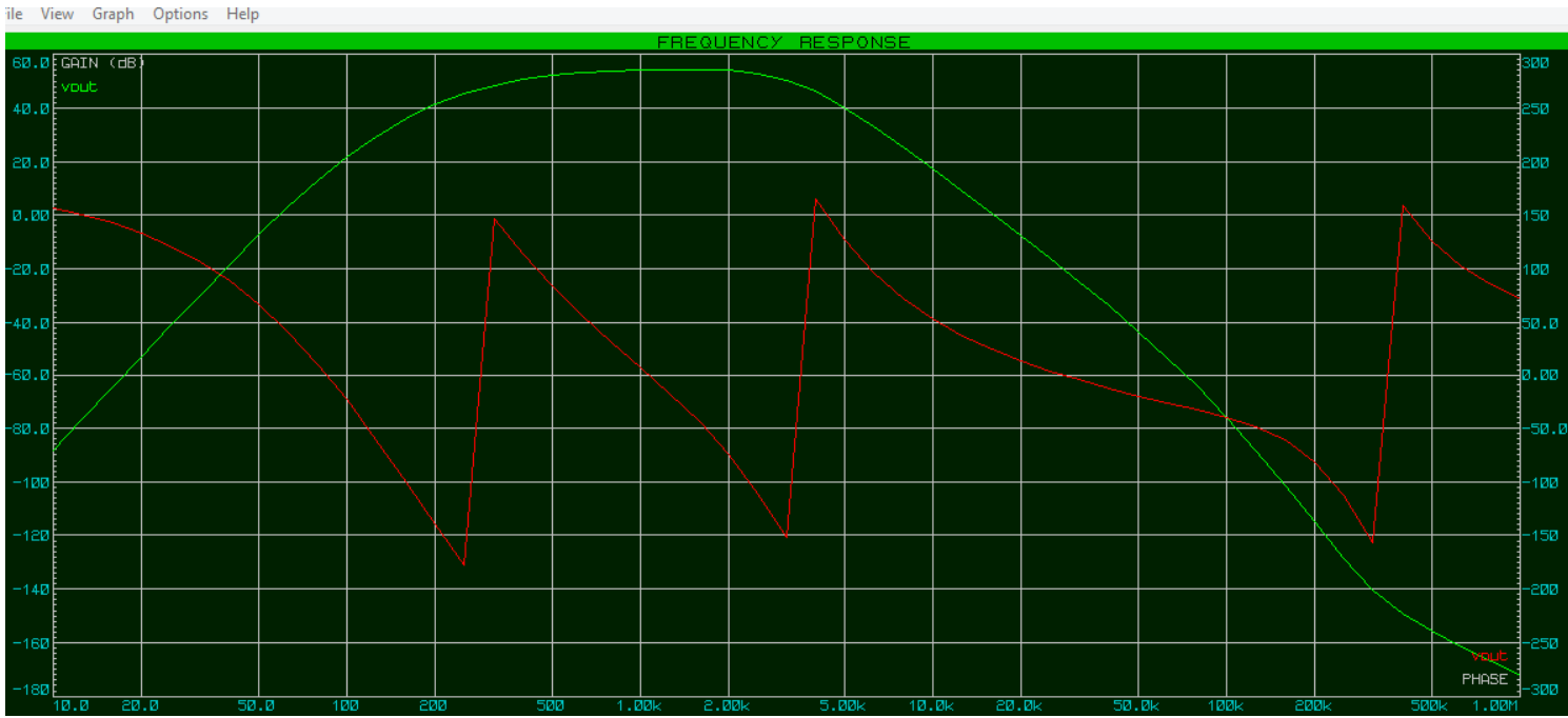
Figure 52: La réponse en fréquence des trois filtres simulée par ISIS.
