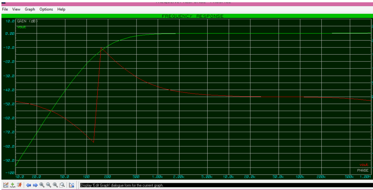
Figure 46: Réponse en fréquence sous ISIS : Module dB et la phase de filtre passe-haut
