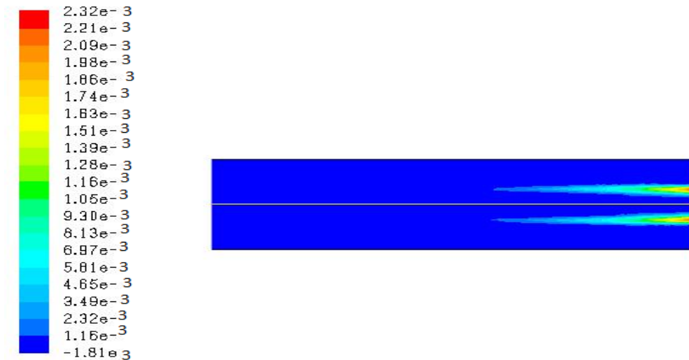
Figure 4.8 : Contour présente les différentes variations de la concentration NOx
