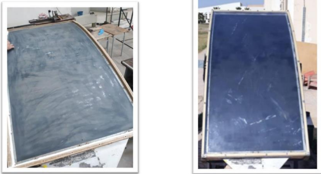
Fig. II.11. Le capteur curviligne étudié avant et après la préparation. [36]
