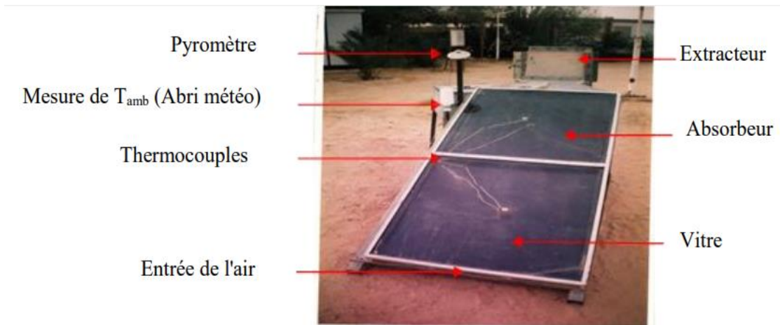
Fig. II.5. Capteur solaire à air réalisé. [31]
