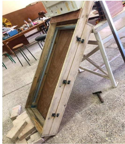
Fig. IV.2. Rôle des tirants métalliques
