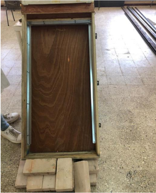
Fig. IV.1. Caisson et support d'absorbeur
