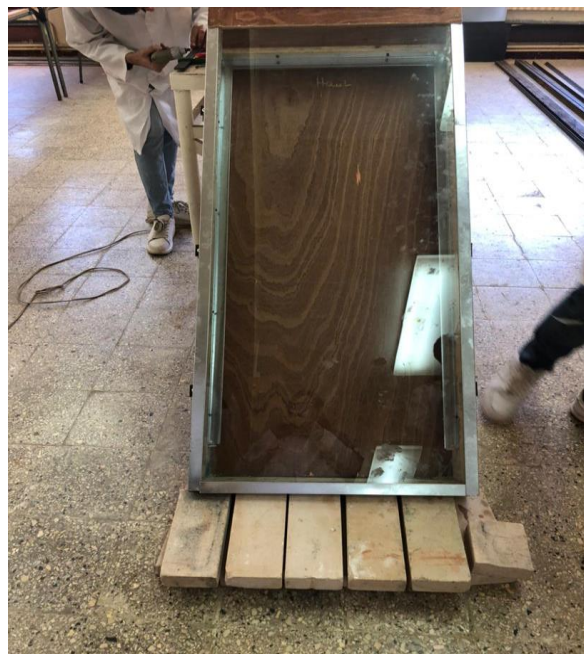
Fig. IV.6. Vitrage au-dessus de l'absorbeur
