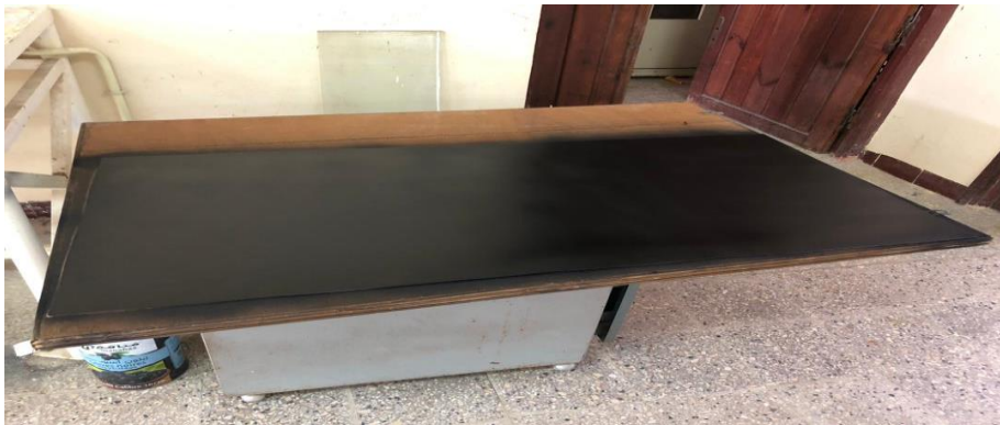
Fig. IV.3. Absorbeur plat en noir mate
