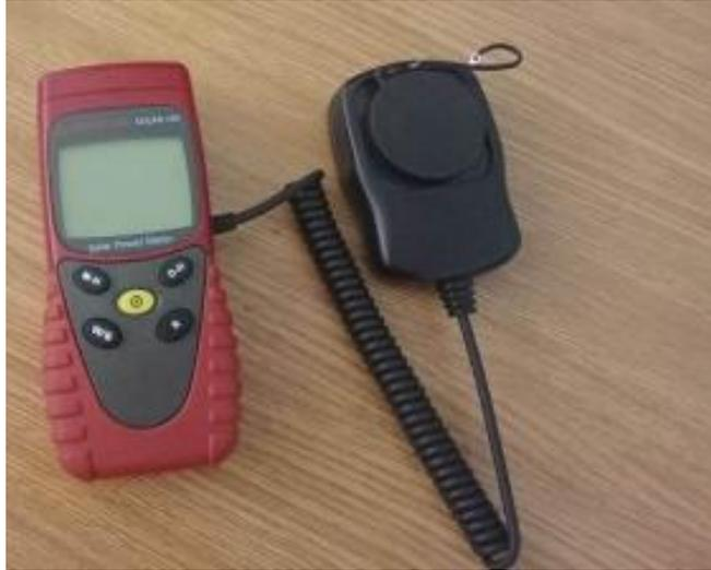
**Figure II.9:** Solarimètre
