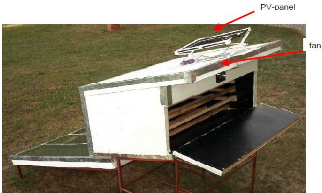
**Figure I.7** : Ventilateur alimenté par un panneau photovoltaïque.
