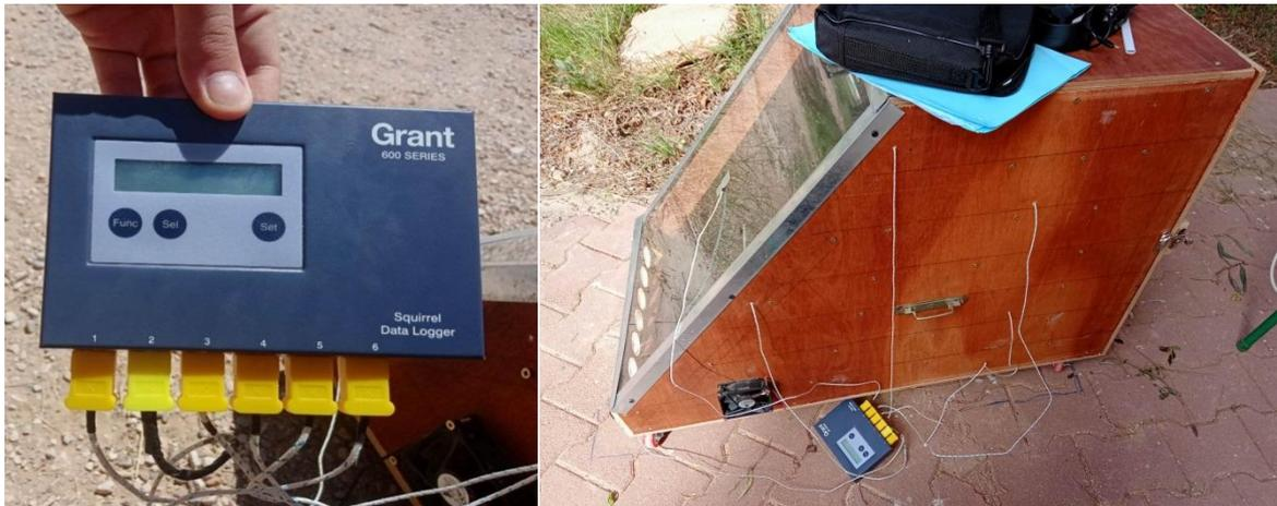
**Figure II. 7:** Enregistreur de température et sa position sur le séchoir solaire indirect
