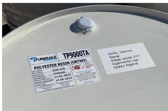
**Figure III-23 : Résine polyester ORTHO.**
