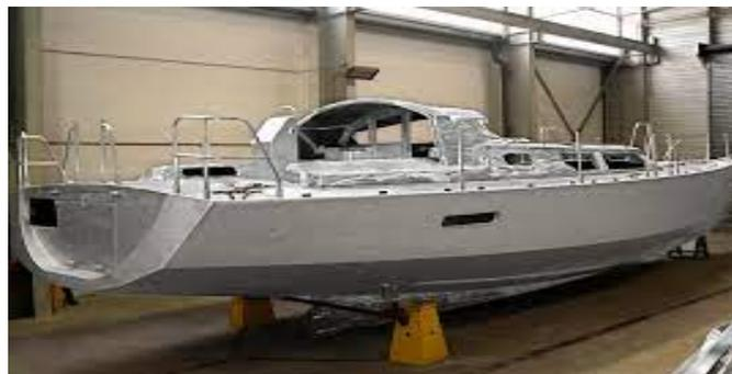
**Figure II-11 :Navire avec une coque en aluminium**
