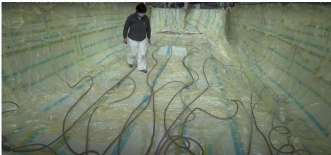
Figure II-13 : Procède de moulage par injection basse pression (R.T.M.)
