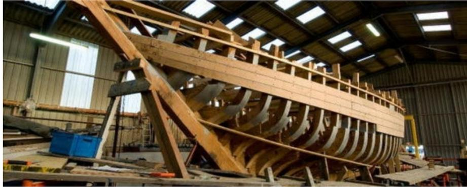
**Figure II-9 :Construction d'un navire en bois.**
