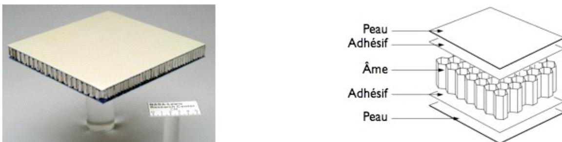
Figure I-5 : Structures en sandwich.
