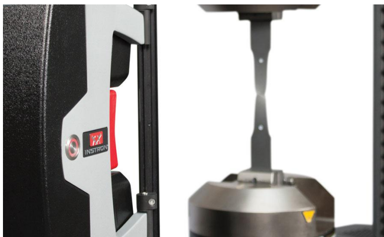
Figure 1.3 Extensomètre vidéo pointant vers une éprouvette
