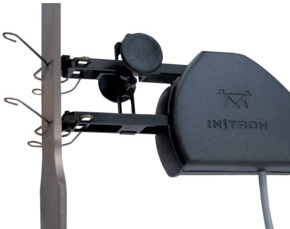
Figure 1.1 Extensomètre à pince attaché à une éprouvette d'essai
