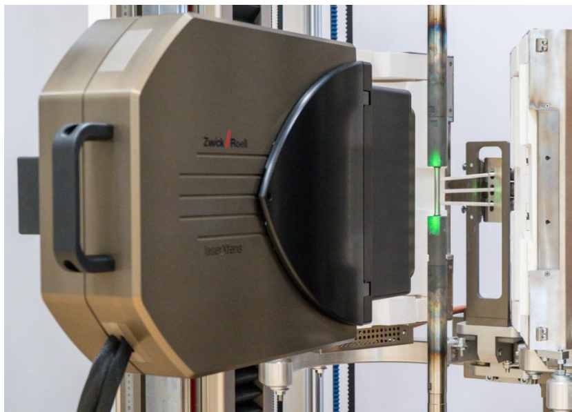
Figure 1.4 Extensomètre laser pointant vers une éprouvette [3]
