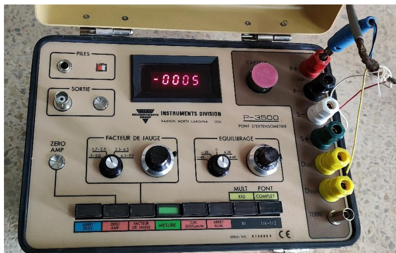
Figure 3.10 Photo du montage au appareil P-3500
