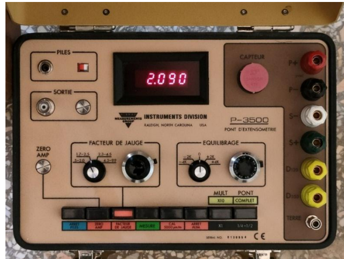
Figure 2.9 P-3500 en mode réglage du facteur de jauge
