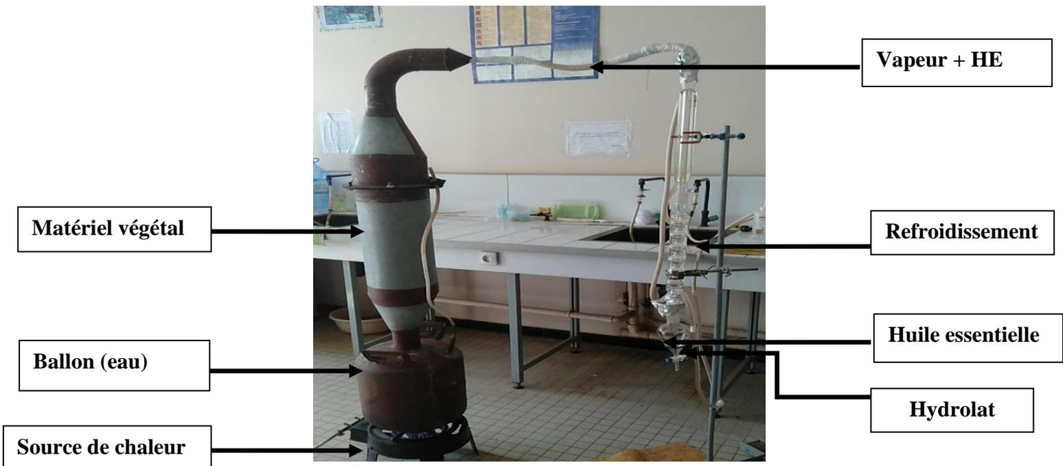
**Figure 6 :** Dispositif d'extraction des huiles essentielles par entraînement à la vapeur d'eau (Tlemcen, Mars 2023).
