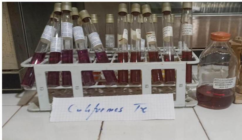
**Figure4:** milieux utilisé pour la mise en évidence des coliformes totaux dans le lait et autres échantillons (Original, 2023)
