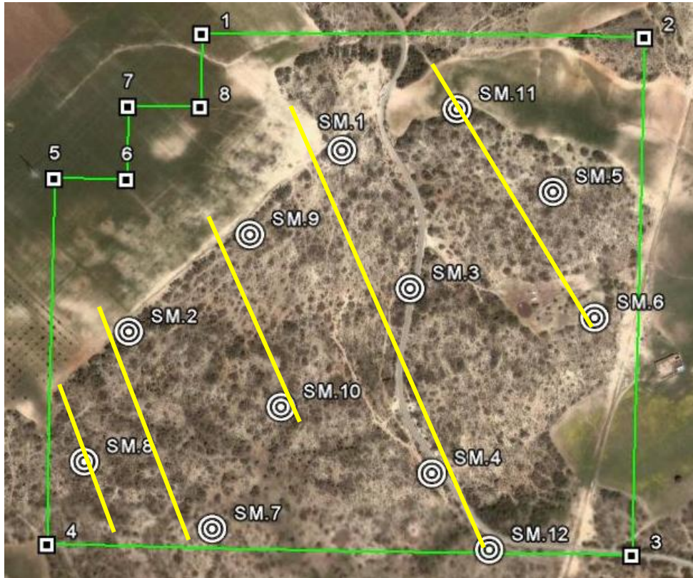
Figure 14 : les sondages carottés réalisés de Menatsia et les tracés des profils (Google Earth).
