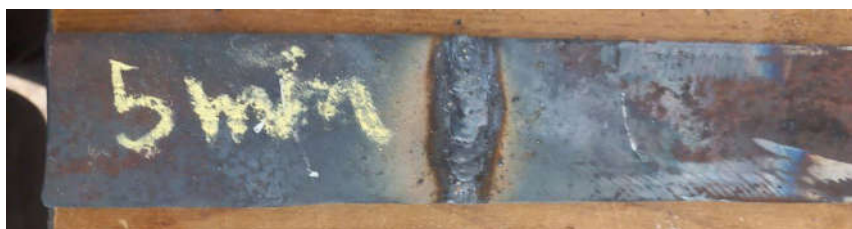
Figure 12 éprouvette de e = 3 \text{ mm} soudée avec préchauffage de 5 min
