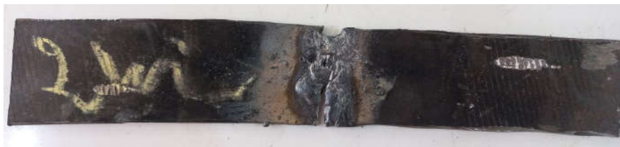
Figure 35 éprouvette de e=3\text{ mm} soudée avec préchauffage de 2 min après traction
