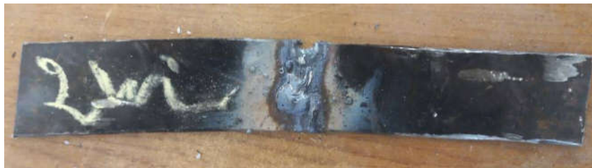
Figure 11 éprouvette de e = 3 \text{ mm} soudée avec préchauffage de 2 min
