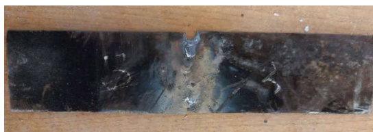
Figure 5 éprouvette de e = 1 \text{ mm} soudée avec préchauffage de 5 min
