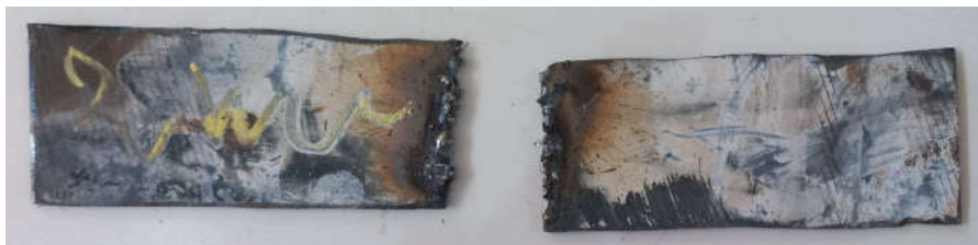
Figure 31 éprouvette de e = 2.5 \text{ mm} soudée avec préchauffage de 2 min après traction
