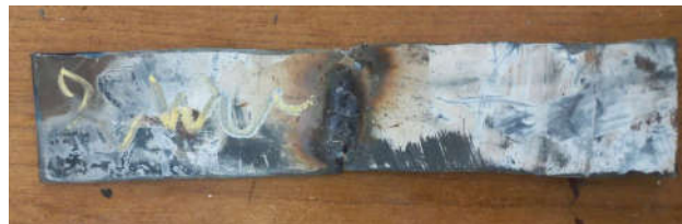
Figure 7 éprouvette de e = 2.5 \text{ mm} soudée avec préchauffage de 2 min
