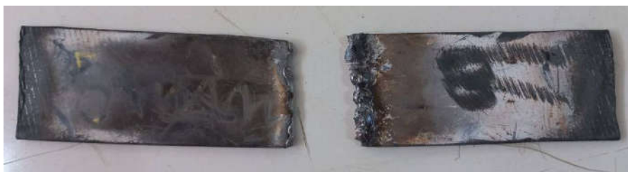
Figure 32 éprouvette de e = 2.5 \text{ mm} soudée avec préchauffage de 5 min après traction
