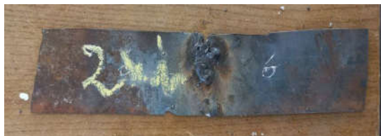
Figure 4 éprouvette de e = 1 \text{ mm} soudée avec préchauffage de 2 min
