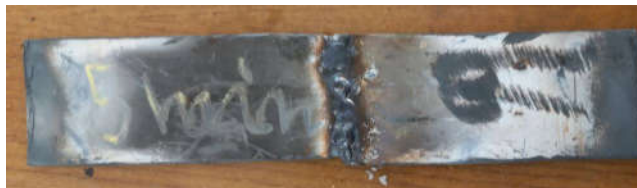
Figure 8 éprouvette de e = 2.5 \text{ mm} soudée avec préchauffage de 5 min
