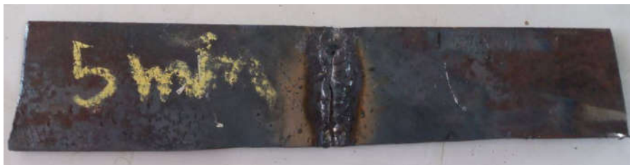
Figure 36 éprouvette de e=3\text{ mm} soudée avec préchauffage de 5 min après traction
