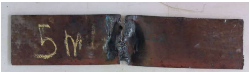
Figure 28 éprouvette de e = 1 \text{ mm} soudée avec préchauffage de 5 min après traction
