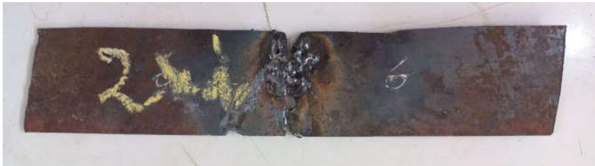
Figure 27 éprouvette de e = 1 \text{ mm} soudée avec préchauffage de 2 min après traction
