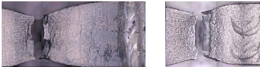
Figure 25 : Ruptures par clivage après sous essai de traction d'une soudure réalisée par TIG, pour (a) éprouvette non grenillée, (b) Eprouvette grenillée [17]
