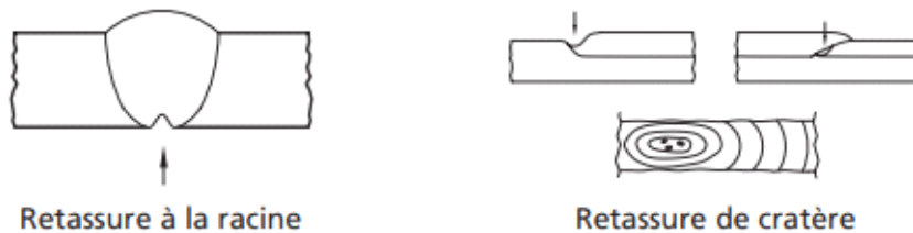
Figure 10 : Défaut de retassures et criques [15]
