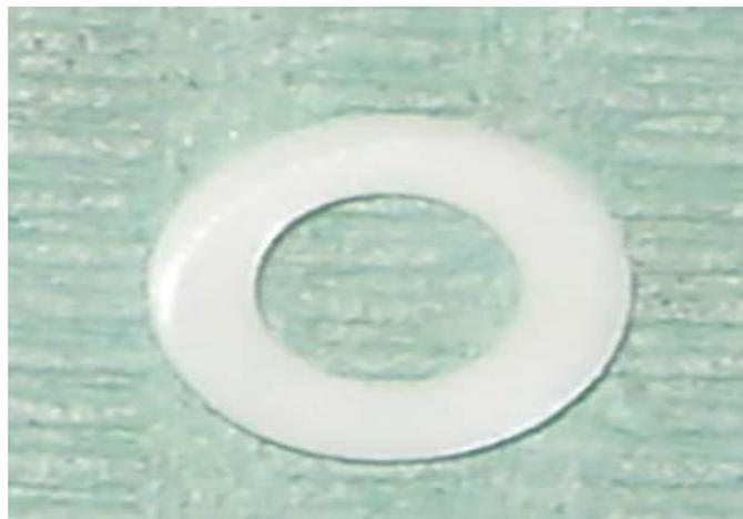
*Figure 42 : Bague de protection blanche en Téflon.*
