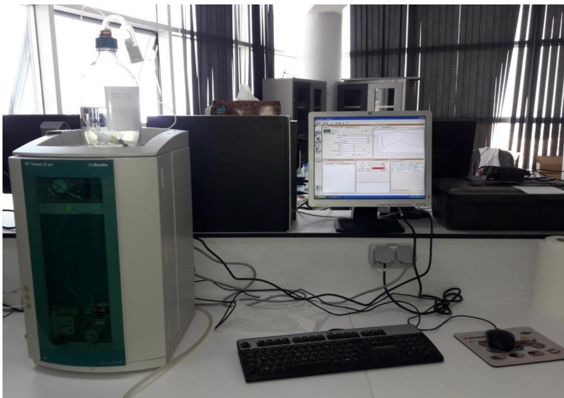
Figure 14- Chromatographie ionique model (881 Compact IC pro).
