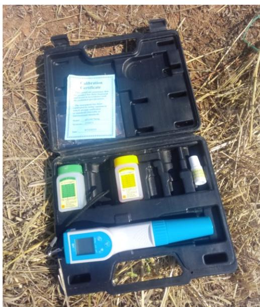
Figure 13a- pH-mètre de type EXTECH.
