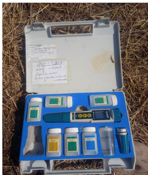
Figure 13b- Multi-paramètre Isolab-Multiparameter.
