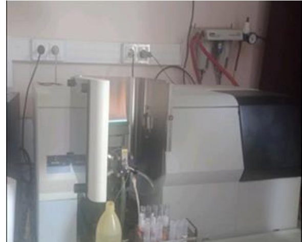
Figure 21. A.A.S. Perkin Elmer PinAAcle 900 séries du laboratoire de recherche Toxicomed de la faculté de médecine Tlemcen
