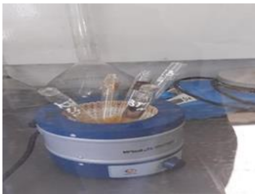
Figure 29. Résidu sec après Evaporation et ajout de 5 ml d'acide nitrique à 0,25%
