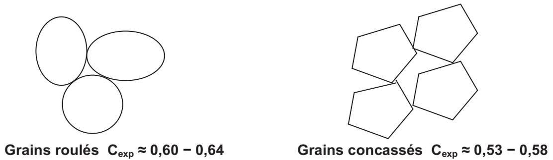
Figure 1.7 valeur des compacités pour des grains roulé et concassé (de Larrard, 2000)
