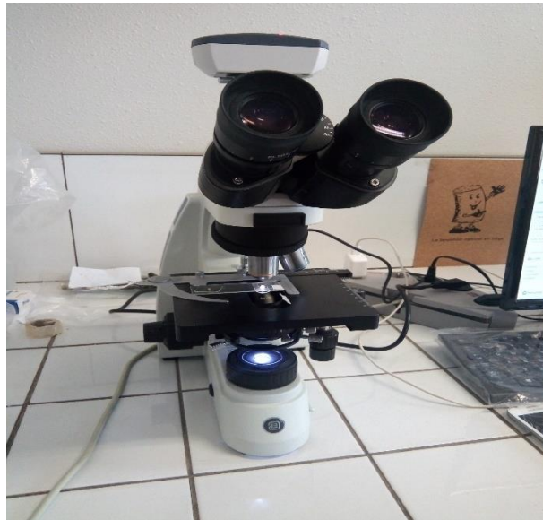
Figure 18: Microscope doté d'un appareil photos et d'un logiciel de mesure.
