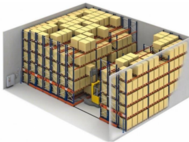
Figure 1.11: AS/RS à racks glissants
