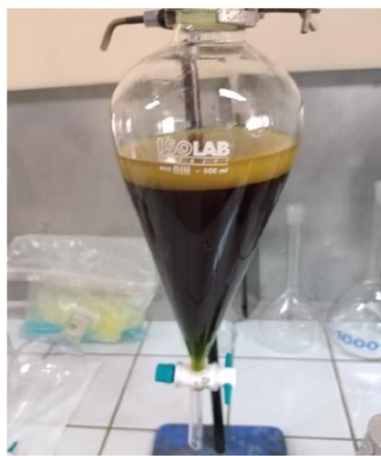
Figure 14: Elimination de la chlorophylle par le chloroforme.
