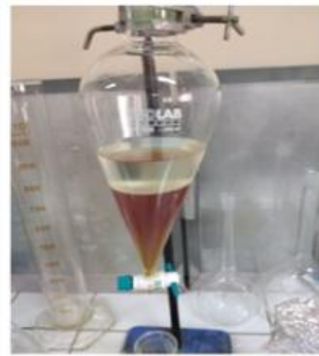
Figure15: Fractionnement de l'extrait brut par l'acétate d'éthyle.
