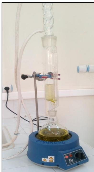
**Figure 09** : Extraction par l'appareil de soxhlet
