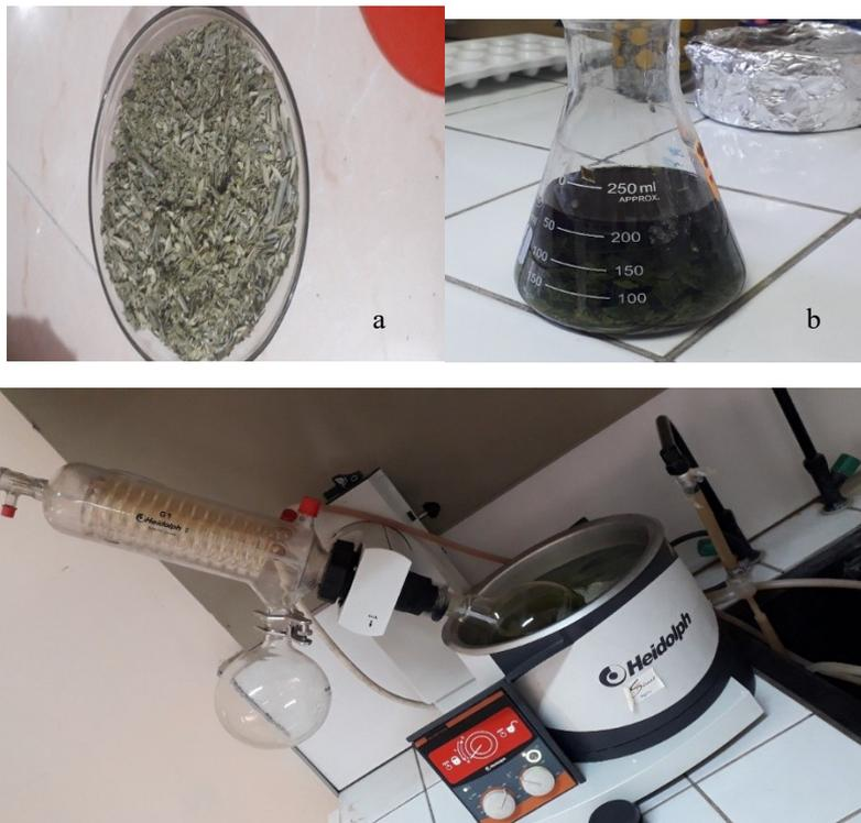
**Figure 5 :** Feuilles de l’olivier (a), extrait hydroalcoolique (b) et évaporation de l’extract par un rotavapeur (c)
