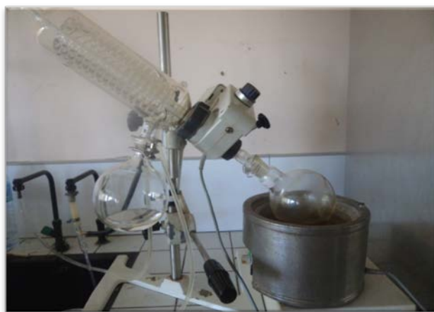
Figure 28 : Evaporation du solvant à rotavapor
