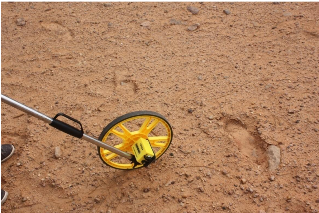
Photos 02 : Roue de mesure de distance pour délimiter les placettes de relevés d'ensablement
