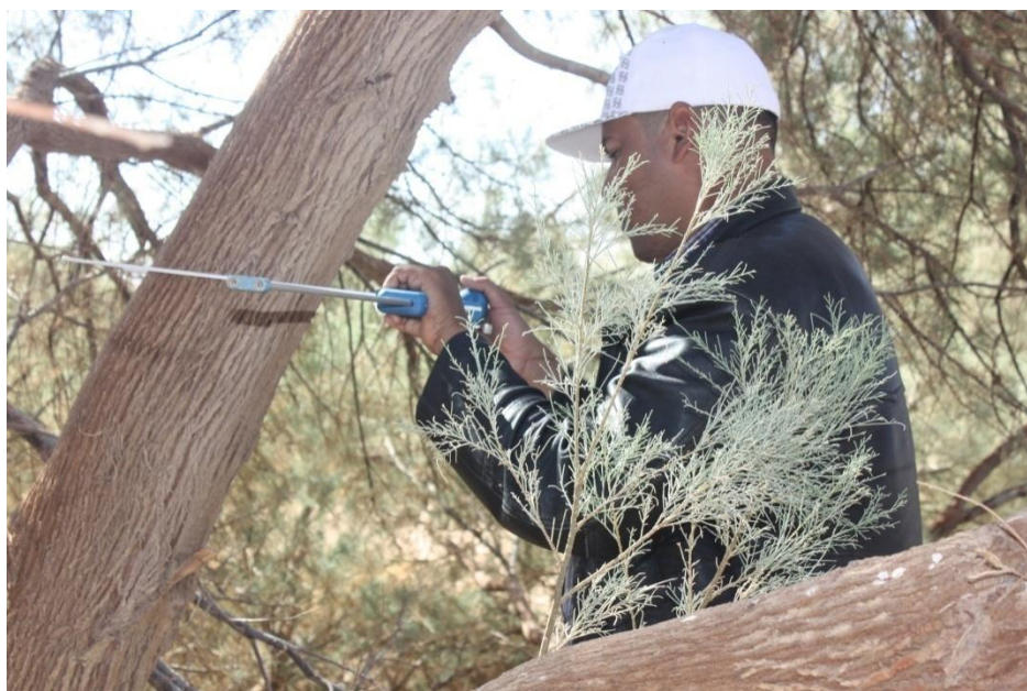
Photo 8: Mesure de diamètre d'un arbre de Tamarix en utilisant le compas forestier, bande verte (C)
