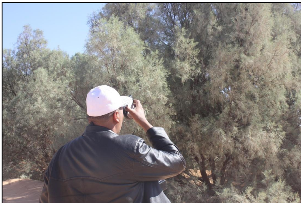
Photo 7: Mesure de la hauteur d'un arbre (> 8m) de Tamarix en utilisant le Blum-Leiss bande verte d'Ouadjda
