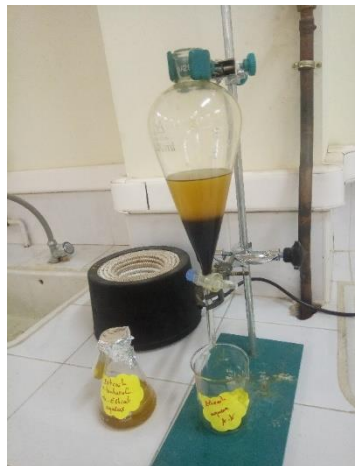
Figure n°08 : Montage de l'extraction liquide- liquide des extraits bruts de H.tuberculatum
