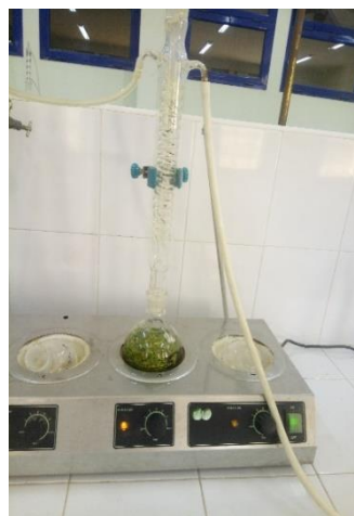
Figure n°07 : Montage de l'extraction par décoction sous reflux de la partie aérienne H. tuberculatum
