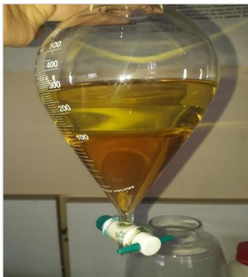
**Figure 09 :** Fractionnement liquide-liquide de l'extrait brut hydro-méthanolique à l'aide d'une ampoule à décanté
