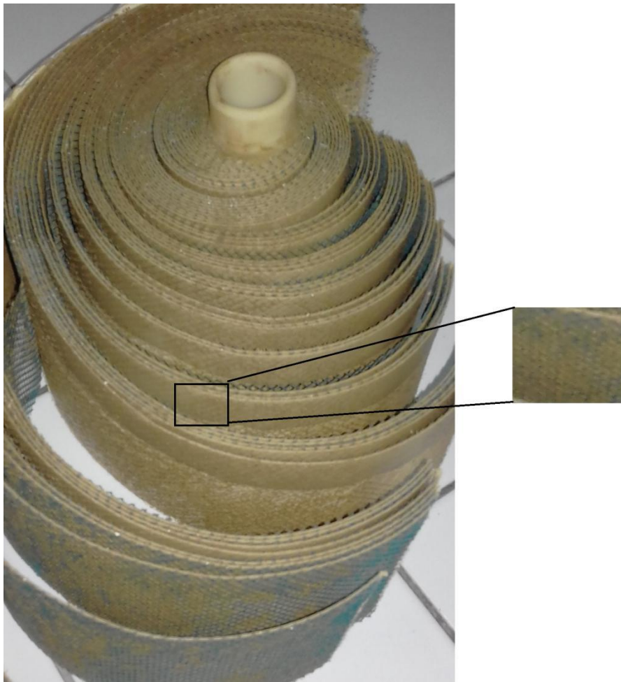
Figure 4: Membrane de nanofiltration encrassée prélevée de la station de dessalement d'eau de mer de souk T'lata-Tlemcen.
