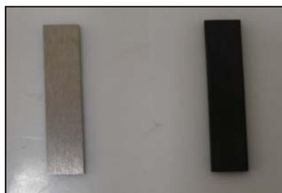
Figure IV.8. Oxydation de la plaque après un chauffage thermique
