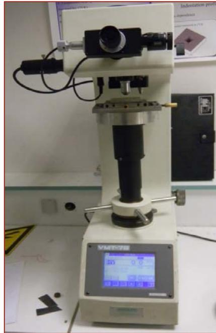
Figure III.6. Dureté Vickers
