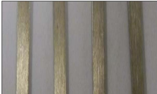
Figure III.1 Verre métallique massif  $Zr_{55} Cu_{30} Al_{10} Ni_5$  synthétisé sous forme de plaque par Y.Kawamura .
