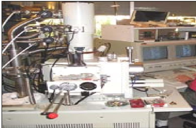
*Figure IV.16: Microscope électronique a balayage JSM 6400*
