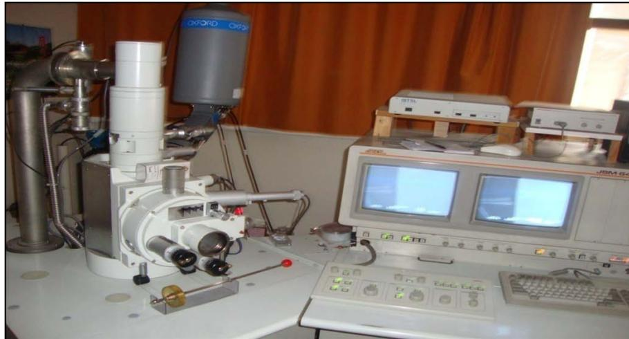
Figure IV.19: Microscope électronique a balayage JSM 6400
