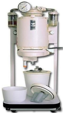
Figure 29.Préparation du plâtre sous vide[22]
