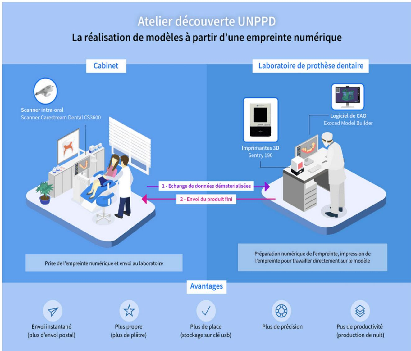
Figure 58. la réalisation de modèles à partir d'une empreinte numérique. [24]
