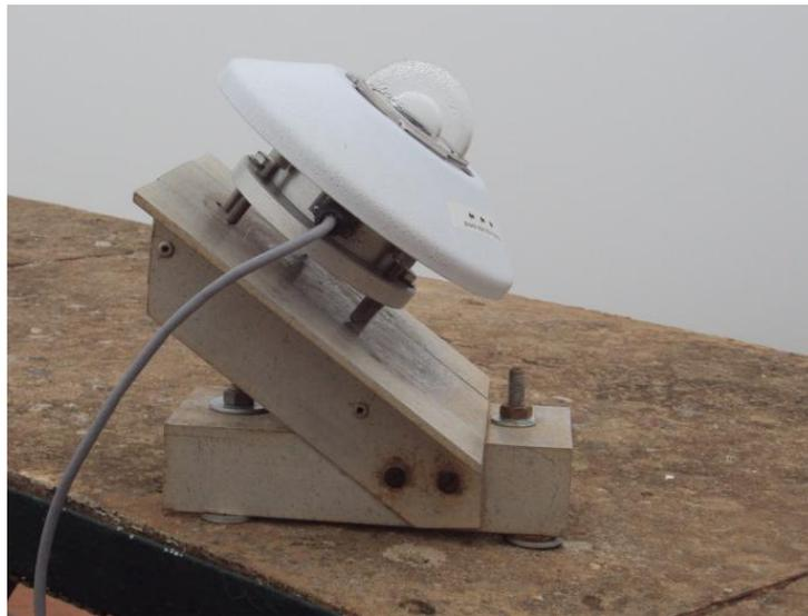
Figure 19. Pyranomètre pou la mesure du rayonnement global sur plan incliné. CDER de Bouzareah
