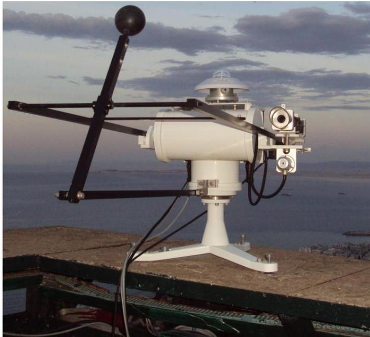
Figure 17 .Station radiométrique du CDER de Bouzareah pour la mesure du rayonnement direct et le rayonnement diffus sur plan horizontal
