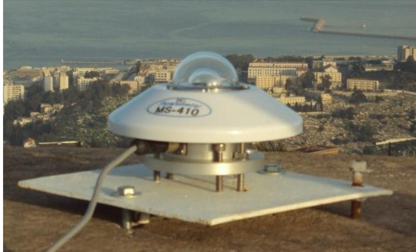
Figure 18 .Pyranomètre qui mesure du rayonnement global sur plan horizontal
