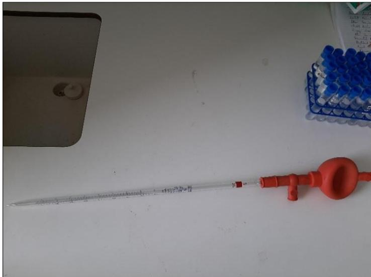
**Figure 17 :** Pipette graduée 5 ml avec poire.
